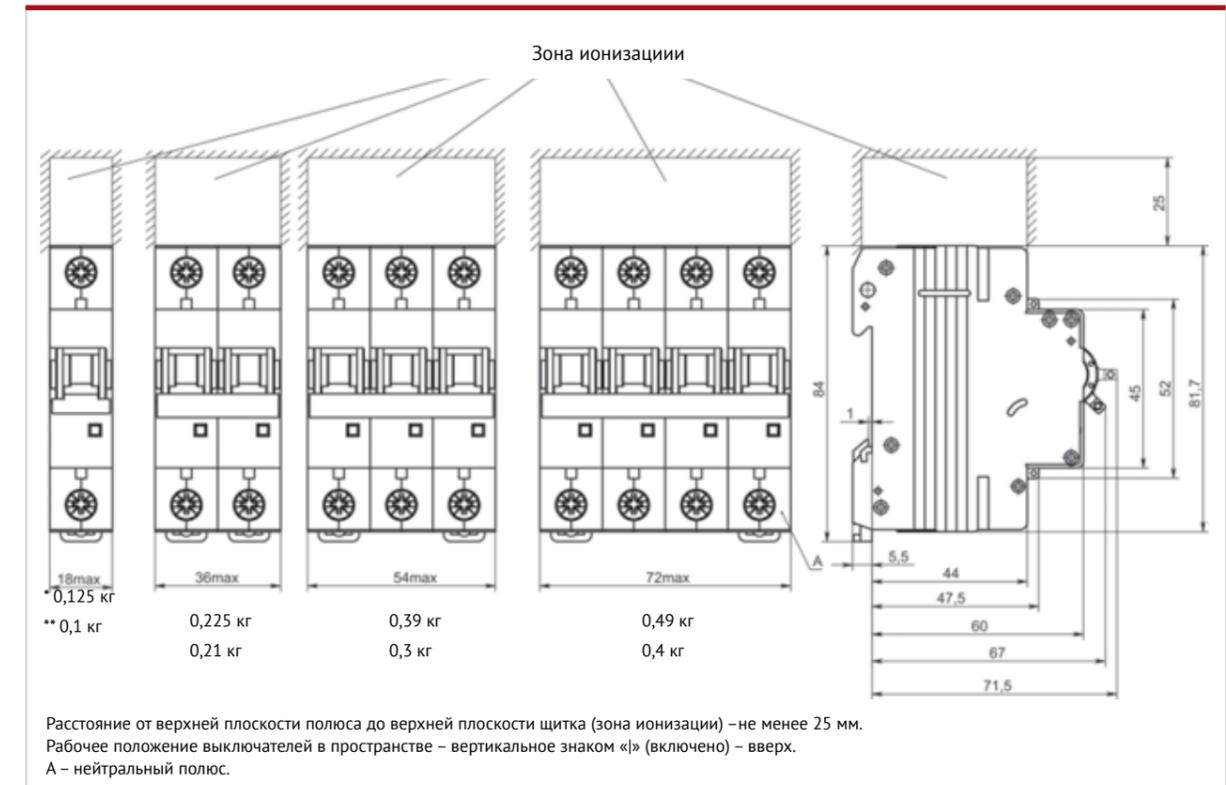
Габаритные и установочные размеры модуля свободных и сигнальных контактов. Масса, не более
