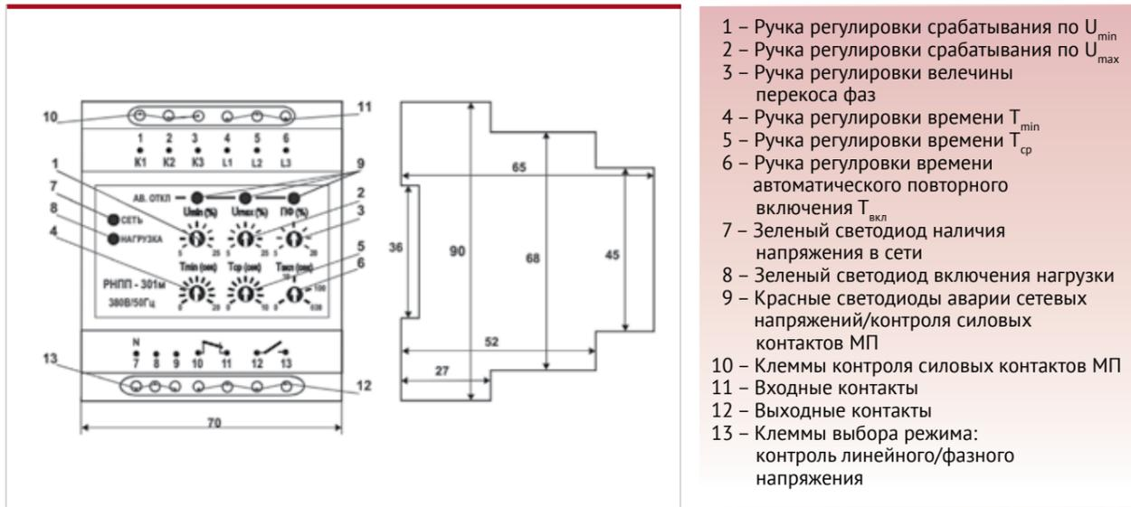
Схема подключения реле
