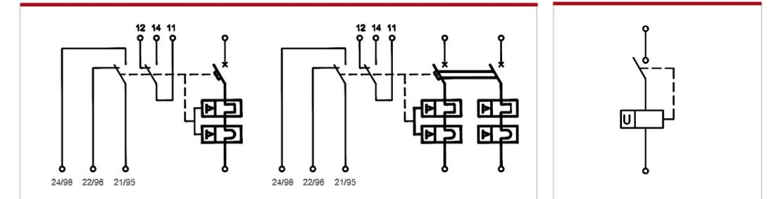
Принципиальная электрическая схема независимого расцепителя в отдельном модуле
