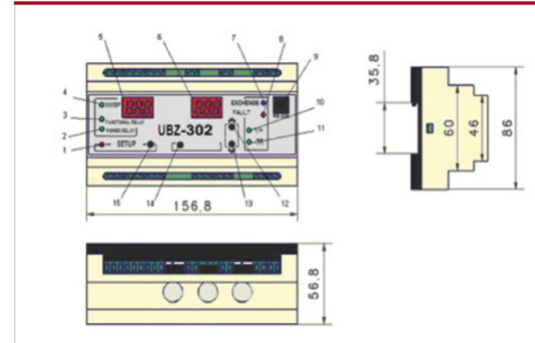
1. Зеленый светодиод УСТАНОВКА - горит, когда реле находится в режиме установки параметров
