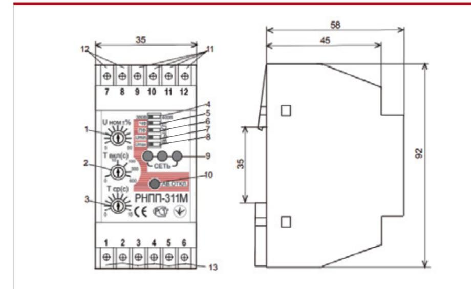
1. Регулировка порога срабатывания по  $U_{max}/U_{min}$
