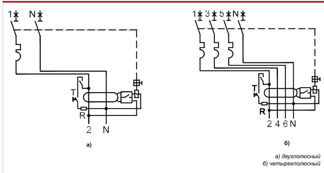
Конструкция дифференциального автомата представляет собой соединение двух функциональных узлов: электронного модуля дифференциальной защиты и автоматического выключателя OptiDin BM63.
