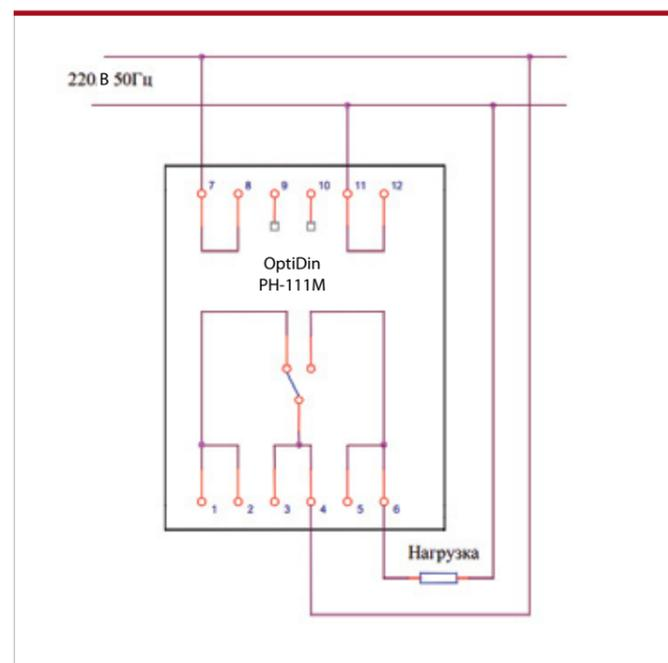
Реле напряжения OptiDin PH-113
