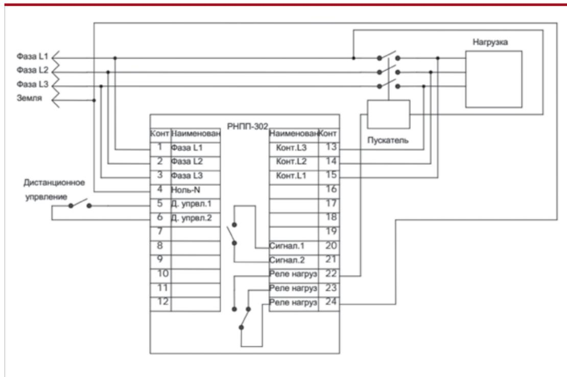
Примечание – При подключении реле в сети с изолированной нейтралью, ноль-N (клемма 4) можно не подключать.
