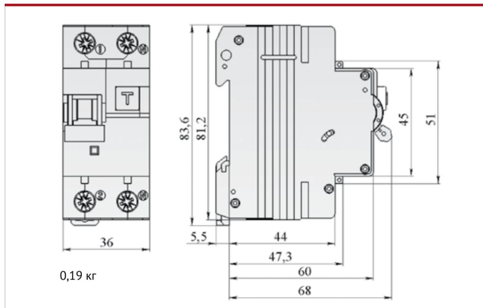
В основе действия защитного отключения, лежит принцип ограничения (за счет быстрого отключения) продолжительности протекания тока через тело человека при непреднамеренном прикосновении его к элементам электроустановки, находящимся под напряжением.
