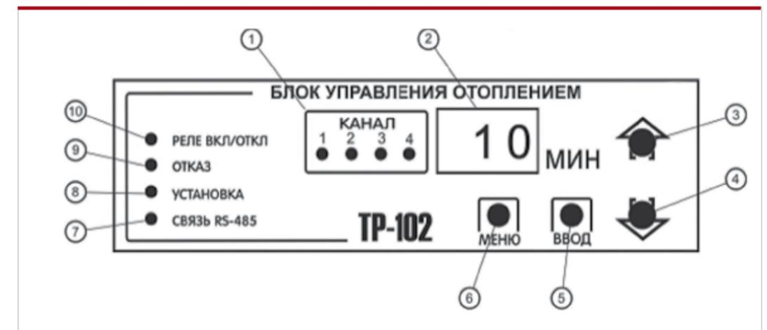
1. Индикатор номера текущего контролируемого канала
