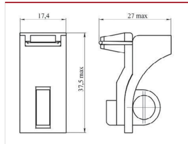
Диаметр дужки навесного замка не более 8 мм.
